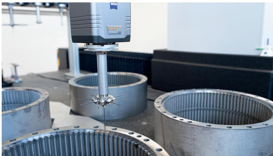
Bild z. Vier auf einen Streich: Auf dem Koordinatenmessgerät werden über Nacht vier Verzahnungsringe geprüft. (© Zeiss)
